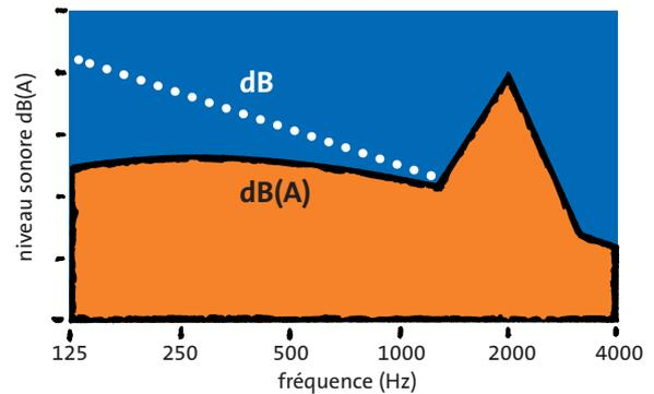
la fréquence critique. C'est la fréquence à laquelle le verre vibre suite à un choc. A cette fréquence, le bruit est transmis plus facilement et nous obtenons un pic sonore.
