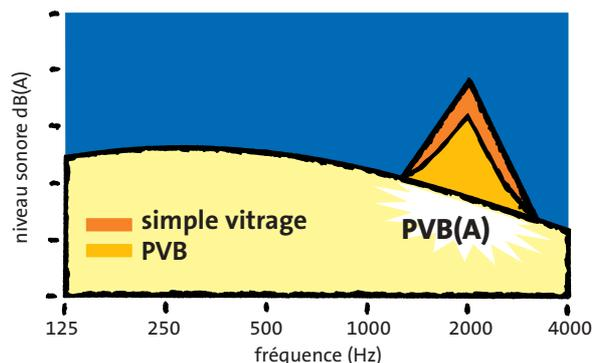
\* Les graphiques illustrent les paramètres qui influencent la transmission du bruit au travers d'un simple vitrage. Nous partons d'un spectre plat du côté émetteur. Pour les valeurs d'isolation acoustique exactes, nous nous référons à notre documentation technique et aux rapports d'essais officiels.
